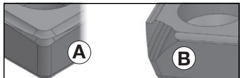
Figura A: desgaste normal: dar la vuelta / sustituir la plaquita intercambiable.
