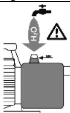
Pumpengehäuse mit Wasser auffüllen.
