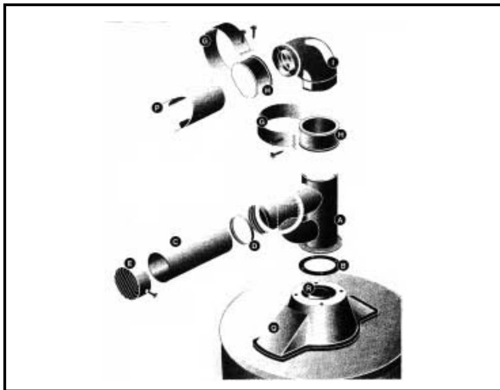
Obr. 6: Sada na oddělený přípov vzduchu a odtah spalín - jednotlivé části:
