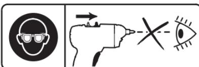
► Pri zamjeni alata nosite zaštitne naočale. Ne gledajte izravno u stezać alata. Pri zamjeni radnog alata isti bi se mogao odbaciti prema naprijed.
