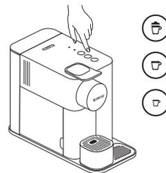
**4** Enjuague la máquina colocando un recipiente de 500 ml debajo del orificio de salida del café y pulsando el botón Lungo. Repita 3 veces.
