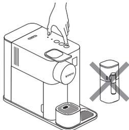
**2** Druk de melkdrankknop 3 seconden in om de menumodus te activeren: de ontkalkings- en reinigingslampjes beginnen te knipperen.
