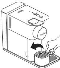
A gép kicsomagolásakor távolítsa el a védőfoliát, a víztartályt, a csepegtetőt és a kapszulatartót. Állítsa be a kábel hosszát, majd a maradék kábelt helyezze el a gép alatt. Távolítsa el a rácson található matricát. A gépet regisztrálhatja a [www.nespresso.com](http://www.nespresso.com) oldalon.
