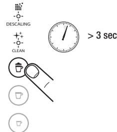
**3** Naciśnij przycisk służący do przygotowania napoju mlecznego. Przycisk służący do przygotowania napoju mlecznego miga, wskazując pracę w trybie przywracania ustawień. Naciśnij przycisk, aby zatwierdzić operację. Wszystkie przyciski zamigają 3 razy – wszystkie wartości objętości zostały przywrócone do ustawień fabrycznych. Menu wyłączy się automatycznie i ekspres powróci do trybu gotowości.
