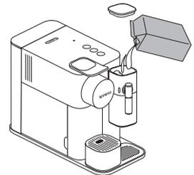
Atenção: Quando deitar o leite no depósito, tenha o cuidado de não o deixar transbordar. Se necessário, limpe cuidadosamente com um pano. Não pose a embalagem do leite no depósito do leite, dado que ele se poderá desencaixar da máquina.
