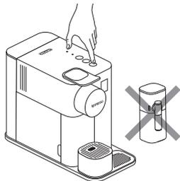
**2** Stiskněte tlačítko pro nápoj s mlékem na 3 sekundy. Tím se spustí režim Menu: kontrolky pro odvápnění a čištění začnou blikat.
