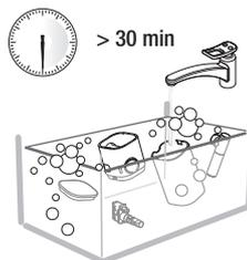
Immergere tutti i componenti in acqua potabile calda (min. 40°C) con un detergente delicato / neutro per almeno 30 minuti e risciacquare abbondantemente con acqua potabile calda.
