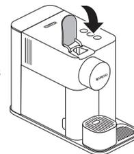
**3** Vacíe la bandeja antigoteo y el contenedor de las cápsulas usadas. Llene el depósito de agua con 100 ml de agente descalcificador **Nespresso** (1 sobre). Añada agua hasta la marca de descalcificación en el depósito de agua (~ 500 ml).
