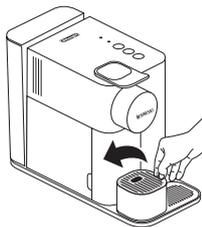
Quando abrir a embalagem da máquina, retire a película de proteção, o depósito de água, a gaveta de recolha de pingos e o compartimento de cápsulas usadas. Ajuste o comprimento do cabo e guarde o excedente sob a máquina. Retire o autocolante da grelha. É possível registar a máquina em [www.nespresso.com](http://www.nespresso.com).
