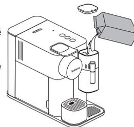
Upozornenie: pri nalievaní mlieka do nádoby dávajte pozor, aby nepretieklo. Rozliate mlieko dôkladne odstráňte handričkou. Balenie mlieka nepokladajte na nádobu na mlieko, aby sa od kávovaru neodtrhla.
