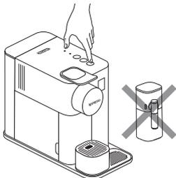
**2** Naciśnij i przytrzymaj przez 3 sekundy przycisk służący do przygotowania napoju mlecznego w celu aktywacji trybu Menu: diody odkamieniania i czyszczenia zaczną migać.
