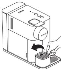
Après avoir déballé la machine retirez le film plastique, le réservoir d'eau, le bac d'égouttage et le bac à capsules usagées. Réglez la longueur du câble et rangez le câble en excès dans l'espace prévu à cet effet sous la machine. Retirez le film adhésif sur la grille repose-tasse. Il est possible d'enregistrer la machine sur [www.nespresso.com](http://www.nespresso.com).
