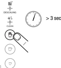
**3** Stiskněte tlačítko Mléko. Tlačítko bliká a signalizuje režim obnovy. Pro potvrzení stiskněte tlačítko. Všechna tlačítka třikrát zablikají: množství se resetuje na tovární nastavení. Režim Menu se ukončí automaticky a kávovar se přepne do pohotovostního režimu.
