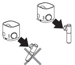
**3** Pulse el botón en el costado del depósito de leche y tire para desbloquear el racor.
