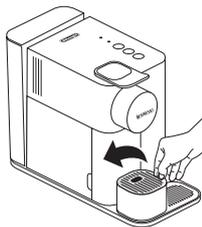
Όταν ανοίγετε τη συσκευασία της μηχανής, αφαιρέστε την προστατευτική μεμβράνη, το δοχείο νερού, το δοχείο συλλογής σταγόνων και το δοχείο χρησιμοποιημένων καψουλών. Ρυθμίστε το μήκος του καλωδίου και στερεώστε το τμήμα που περισσεύει στην ειδική υποδοχή κάτω από τη μηχανή. Αφαιρέστε το αυτοκόλλητο από τη σχάρα. Μπορείτε να δηλώσετε τη μηχανή στην ιστοσελίδα [www.nespresso.com](http://www.nespresso.com).
