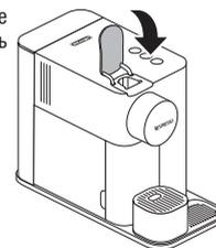
**3** Опорожните поддон и контейнер для использованных капсул. Залейте в резервуар для воды 100 мл средства для удаления накипи Nespresso (1 пакетик). Добавьте воду до отметки удаления накипи на резервуаре для воды (~500 мл).
