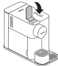
**3** Leeg het lekbakje en de bak voor gebruikte capsules. Vul het waterreservoir met 100 ml **Nespresso** ontkalkingsoplossing (1 zakje). Voeg water toe tot aan het ontkalkingsteken op het waterreservoir (ong. 500 ml).
