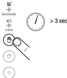
**3** Drücken Sie die Milchtaste. Die Taste blinkt, wodurch der Rücksetzungsmodus angezeigt wird. Drücken Sie die Taste zur Bestätigung. Alle Tasten blinken 3 Mal: die Mengen werden auf die Werkseinstellungen zurückgesetzt. Die Maschine verlässt das Menü automatisch und kehrt in den betriebsbereiten Zustand zurück.
