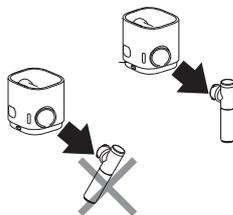
**3** Naciśnij przycisk umieszczony z boku spieniacza i pociągnij element łączący, aby go odblokować.
