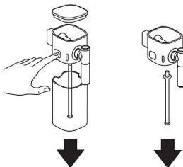
**2** Der Milchauslauf muss in senkrechter Stellung ausgebaut und wieder eingebaut werden.
