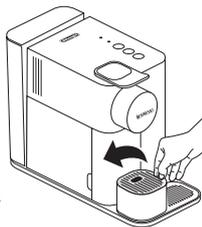
Při rozbalování kávovaru odstraňte ochrannou fólii, vyberte nádržku na vodu, zbernú misku a nádobu na použité kapsuly. Upravte dĺžku prívodného kábla a prebytočnú časť uložte do držáka na spodnej časti kávovaru. Odstráňte nálepku z mriežky. Svoj kávovar môžete registrovať na stránkach [www.nespresso.com](http://www.nespresso.com).
