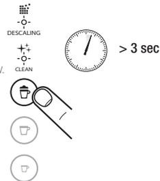
**3** Druk op de melkknop. De knop knippert om de resetmodus aan te geven. Druk om de knop om te bevestigen. Alle toetsen knipperen 3 keer: de hoeveelheden worden teruggezet naar de fabrieksinstellingen. De machine verlaat automatisch het menu en keert terug naar de gebruiksklare machinemodus.
