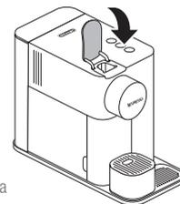
**3** Zdejmij tackę ociekową oraz pojemnik na zużyte kapsułki. Nalej do zbiornika na wodę 100 ml środka odkamieniającego **Nespresso** (1 saszetka). Uzupełnij wodą do kreski „Odkamienianie” na zbiorniku (~500 ml).
