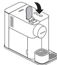
Sollevere e abbassare la leva per espellere le capsule direttamente nel contenitore delle capsule usate.
