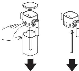
**2** Aby šlo výpusť mléka demontovat a znovu smontovat, otočte ji do svislé polohy.
