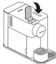
**3** Vyprázdňte odkapávací misku a zásobník na použité kapsle. Do nádrčky na vodu nalijte 100 ml odvápnovacího roztoku **Nespresso** (1 sáček). Roztok doplňte vodou až po značku odvápnění na nádržce na vodu (asi 500 ml).
