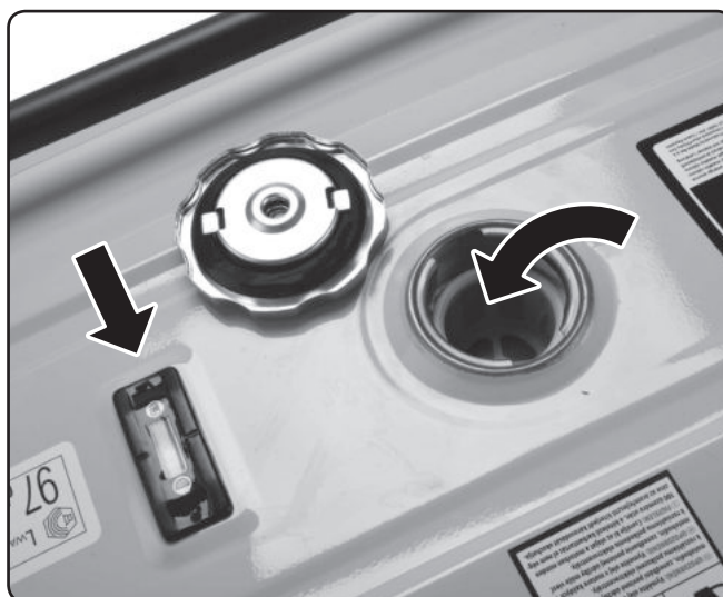
13. ábra. A tartályban lévő üzemanyag mennyiségét mutató kijelző és az üzemanyag szűrőszíta
