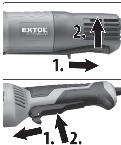
Obr.15; krok 1. odjištění, krok 2. zapnutí
