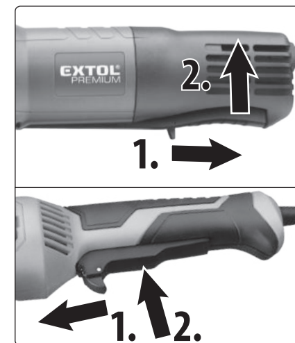
Abb.15; Schritt1. Entriegelung, Schritt 2. Einschaltung
