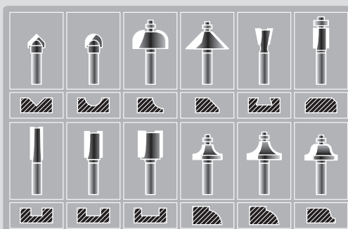
Abb. 1, Profilform an Abhängigkeit vom eingesetzten Profilfräser
