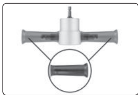
Abb. 2b, Montage des Griffs an einen der Köpfe Fig. 2b, installation of the handle on one of the heads
