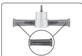
Obr.2b, instalace rukoveti na jednu z hlav
