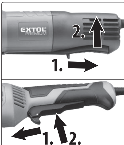
Obr. 15; krok 1. odistenie, krok 2. zapnutie
