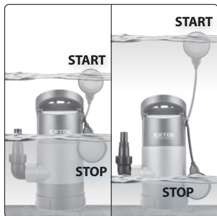
Obr.4, ilustrace funkce plovákového spínače
