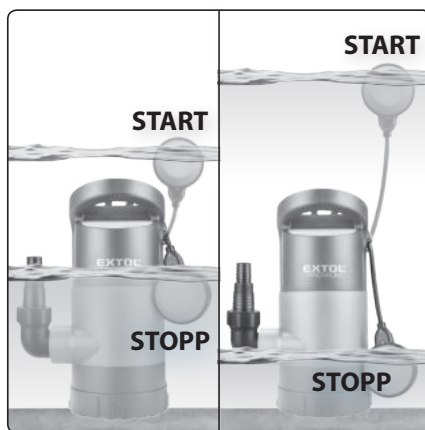
Abb. 4, Darstellung der Schwimmerschalterfunktion
