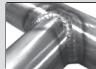
6. ábra. TIG hegesztési eljárással hegesztett rozsdamentes acélcsővek
