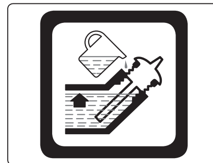
Obr.5, výška hladiny oleje v olejové nádrži
