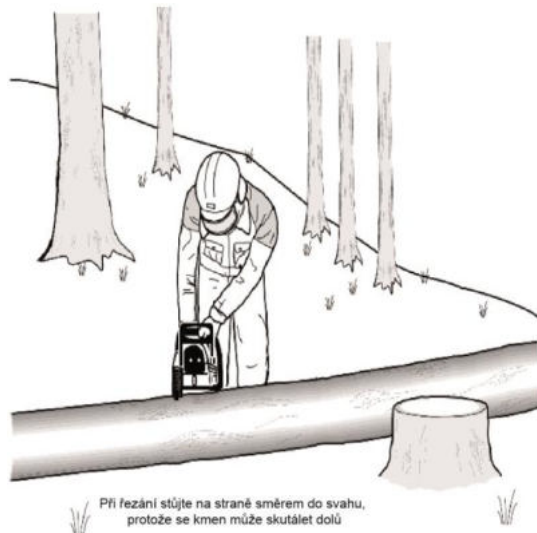
Obr. BB.107-Zkracování kmene
