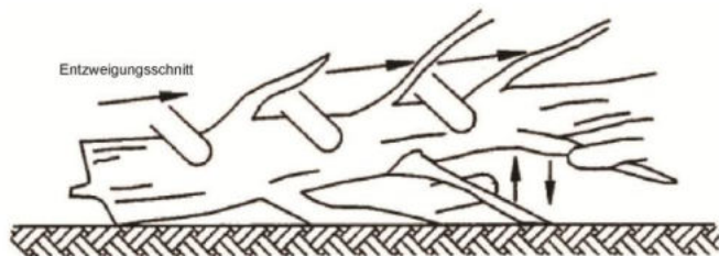
Abb. BB.102 - Beschreibung des Fällens Unterer Schnitt
