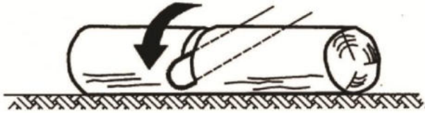
Abb. BB.104 - Stamm in der ganzen Länge abgestützt
