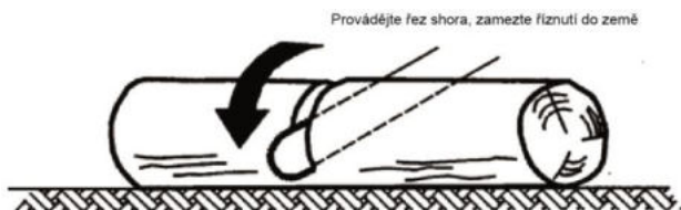
Obr. BB.104-Kmen podepíráný v celé délce
