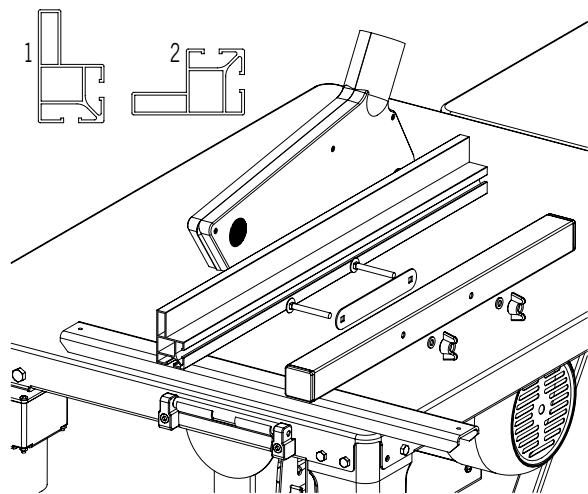
**Montage der Anschlagschiene, Fig. 18**
