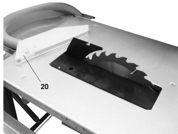
**Fig. 17/17.1, Montaggio dell'arresto longitudinale**
