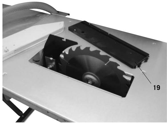
**Obr. 18. Montáž záhytné podpěry.**
