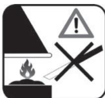
Nevysávejte žhavé uhlíky, hořící předměty, přeměty přesahující teplotu  $40^{\circ}\text{C}$  ( $104^{\circ}\text{F}$ ).
