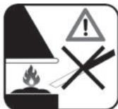
Nevysávajte žeravé uhlíky, horiace predmety, predmety presahujúce teplotu  $40^{\circ}\text{C}$  ( $104^{\circ}\text{F}$ ).
