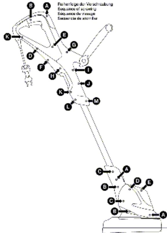
Reihenfolge der Verschraubung
