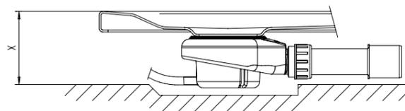
Bei Unterschreitung von Einbauhöhen sind Bodenaussparungen oder Durchbrüche erforderlich. Bei eingesetzter Duschwanne ist auf einen Abstand von mind. 10mm zwischen Siphon und Boden zu achten. Der Anschluss des Siphons an die örtliche Entsorgung und der Schlauch des Kriechwasseranschlusses müssen gegebenenfalls freigestemmt werden. Kaldewei empfiehlt den Einbau einer handelsüblichen Rückfluss-Sicherung in die horizontale Abflussleitung.
