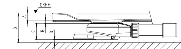
$$A + B\ 13\text{mm} + C + D\ 10\text{mm} = x$$
