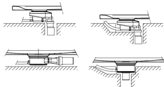
Um ein nachträgliches Verrücken des ausgerichteten ESR II während der weiteren Bauphasen zu vermeiden, sind Bodenbefestigungen im Lieferumfang enthalten. Die Bodenbefestigungen können wie in der Abbildung (je nach Einbausituation) dargestellt positioniert werden. Um eine optimale Schallentkopplung zu gewährleisten, werden die Bodenbefestigungen vor dem Einbau der Duschwanne wieder entfernt.
