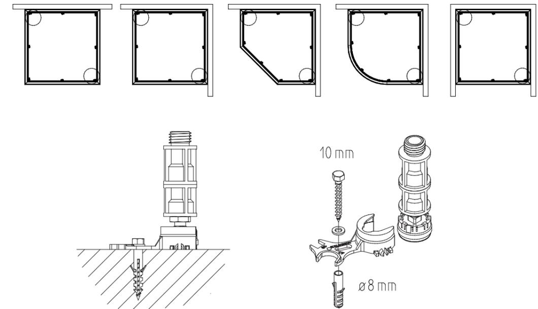
Das clevere Fußsystem ermöglicht verschiedenste Aufbauhöhen und lässt sich flexibel an unterschiedliche Einbauanforderungen anpassen.
