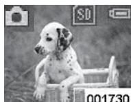
Po włączeniu aparatu, obiekty uchwycone przez obiektyw można zobaczyć na ekranie LCD. Aparat znajduje w trybie fotografowania i jest gotowy do robienia zdjęć. Skieruj aparat na obiekt i naciśnij raz przycisk migawki. Ekran LCD ściemnieje, a następnie przez ~ 1 sekundę pokaże zrobione zdjęcie. Aparat powróci do trybu fotografowania i będzie gotowy do zrobienia następnego zdjęcia. Na ekranie w prawym dolnym rogu widnieje liczba pozostałych możliwych zdjęć do wykonania.
