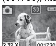
V režimu pořizování snímků můžete obraz přiblížit podržením tlačítka Doprava. Během přiblížení se v levém dolním rohu obrazovky ukáže zvětšení (2,32x). Maximální možné zvětšení je 4x. Podržením tlačítka Doleva se vrátíte do normálního režimu (1x).
