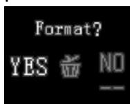
Ak chcete naformátovať kartu SD, prepnite stlačením tlačidla Prehrávanie do režimu prehrávania. Po dvojitém stlačení tlačidla hlavného vypínača uvidíte obrazovku LCD podľa ilustrácie vpravo. Stlačením tlačidla Doľava zvoľte ÁNO (YES). Potom stlačením tlačidla Uzávierky naformátujte kartu SD. Po naformátovaní karty SD sa na obrazovke zobrazí „ŽIADNY SÚBOR“ („NO FILE“) a stlačením tlačidla Prehrávanie sa vráťte do režimu fotografovania.
