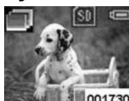
V režime vytvárania fotiek prepnete jedným stlačením tlačidla hlavného vypínača do režimu Menu . Po jednom stlačení tlačidla Doprava sa zobrazí ikona „série“ . Potom sa stisnutím tlačidla Uzávierky vráťte do režimu fotografovania. Uvidíte, že ikona „séria“ zostáva v ľavom hornom rohu obrazovky. Teraz je fotoaparát pripravený po stlačení tlačidla Uzávierky zaobstarať tri zábery po sebe.
