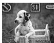
V režimu pořizování snímků přepněte jedním stisknutím tlačítka hlavního vypínače do režimu Menu . Po jednom stisknutí tlačítka Doprava se zobrazí ikona „samospouště“ . Poté se stisknutím tlačítka Závěrky vrátíte do režimu pořizování snímků. Uvidíte, že ikona „samospouště“ zůstává v levém horním rohu obrazovky. Nyní můžete pořídit snímek pomocí samospouště. Snímek se pořídí 10 vteřin po stisknutí tlačítka Závěrky.
