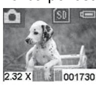
W trybie fotografowania można powiększyć obraz naciskając Prawy Przycisk w sposób ciągły. Powiększenie (2.32x) zostanie pokazane na ekranie w lewym dolnym rogu w trakcie powiększania. Maksymalne powiększenie jakie można osiągnąć to 4x. Naciskając Lewy Przycisk w sposób ciągły, możemy powrócić do normalnego trybu (1x).
