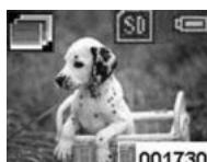
V režimu pořizování snímků přepněte jedním stisknutím tlačítka hlavního vypínače do režimu Menu . Po jednom stisknutí tlačítka Doprava se zobrazí ikona „série“ . Poté se stisknutím tlačítka Závěrky vrátíte do režimu pořizování snímků. Uvidíte, že ikona „série“ zůstává v levém horním rohu obrazovky. Nyní je fotoaparát připraven po stisknutí tlačítka Závěrky pořídit tři snímkы po sobě.
