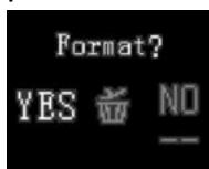
Chcete-li naformátovat kartu SD, přepněte stisknutím tlačítka Přehrávání do režimu přehrávání. Po dvojím stisknutí tlačítka hlavního vypínače uvidíte obrazovku LCD dle ilustrace vpravo. Stisknutím tlačítka Doleva zvolte ANO (YES). Poté stisknutím tlačítka Závěrky naformátujte kartu SD. Po naformátování karty SD se na obrazovce zobrazí „ŽÁDNÝ SOUBOR“ („NO FILE“) a stisknutím tlačítka Přehrávání se vrátíte do režimu pořizování snímků.
