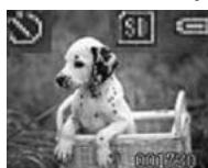
Rögzítő módban nyomja meg a Kapcsoló gombot a Menü módban történő belépéshez . Nyomja meg a Jobb gombot **egyszer** és a „self-timer” ikon megjelenik. Utána nyomja meg a Rögzítő gombot a rögzítő módban való visszalépéshez. A „Self-Timer” ikon a képernyő bal felső sarkában látható. Ilyenkor lehet időzítővel kírásokat készíteni. A kép készítése a rögzítő gomb megnyomása után 10 másodperccel történik.
