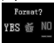
Aby sformatować kartę SD, naciśnij przycisk odtwarzania i przejdź do trybu odtwarzania. Naciśnij przycisk zasilania dwa razy, zobaczyš ekran LCD, jak pokazano obok. Naciśnij przycisk lewy aby wybrać TAK. Następnie naciśnij przycisk migawki by sformatować kartę SD. Gdy karta SD zostanie sformatowana, na ekranie zostanie wyświetlony napis „BRAK PLIKÓW”, możesz nacisnąć przycisk odtwarzania, aby powrócić do trybu fotografowania.
