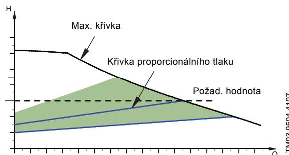
Obr. 6 Výkonový rozsah *AUTOADAPT*
