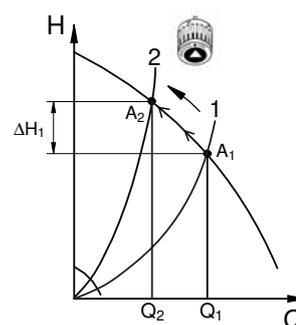
Obr. 7 Neregulované čerpadlo
