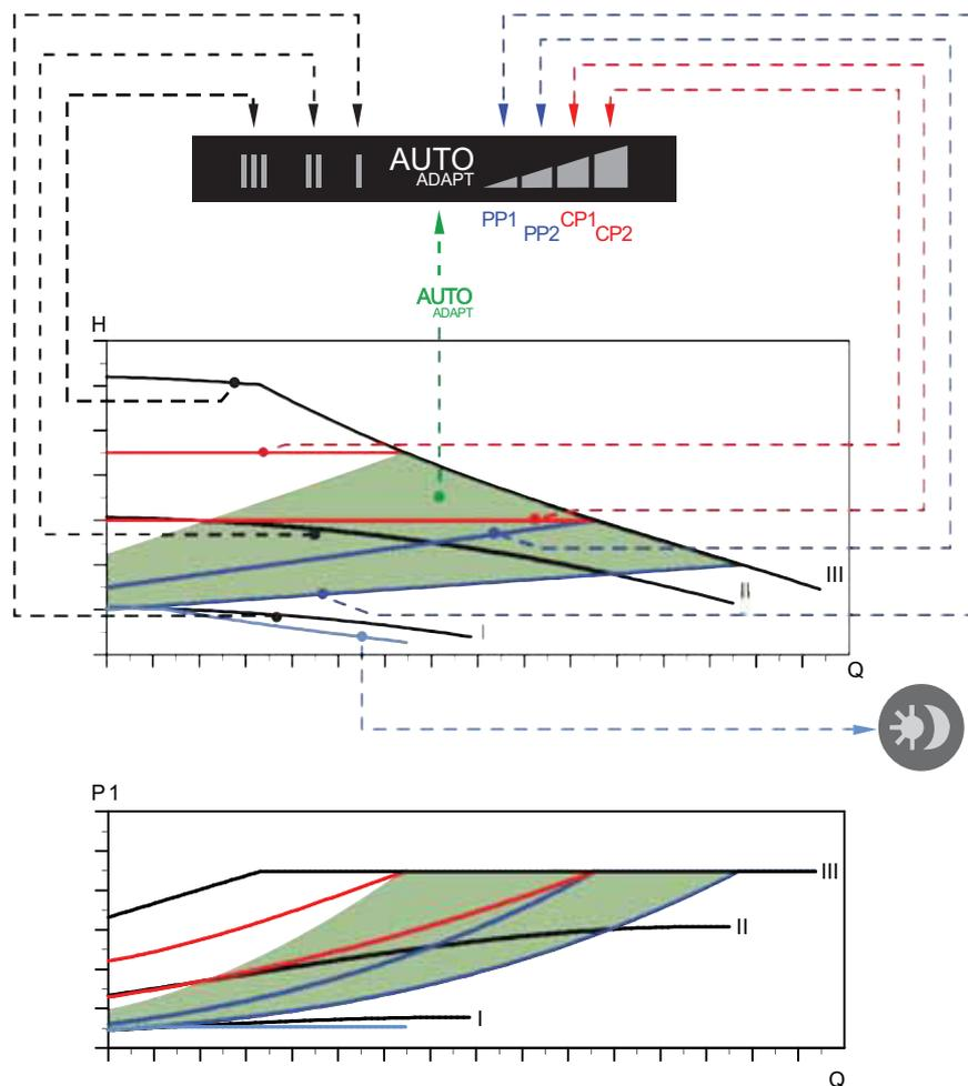
Obr. 17 Charakteristické křivky ve vztahu k nastavení čerpadla
