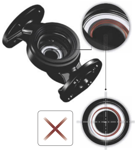
Obr. 12 Nesprávně vystředěná těsnicí soustava
