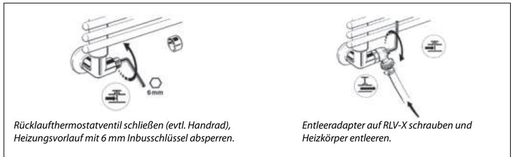
Rücklaufthermostatventil schließen (evtl. Handrad), Heizungsvorlauf mit 6 mm Inbusschlüssel absperren.
