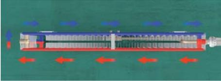
Technologie therm-x2 pracuje na zcela novém principu sériového proudění. To znamená: U dosavadních deskových topných těles se všechny desky zahřívají současně, zatímco zde je proudění směřováno nejdříve do přední desky. Výsledkem je až 11% úspora oproti běžným deskovým topným tělesům.
