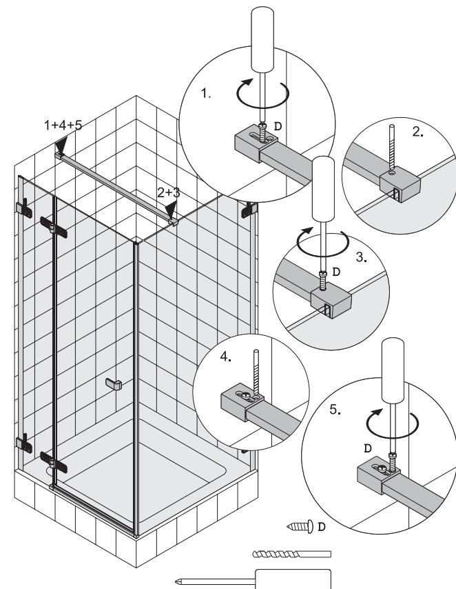
**SK** Upevnite profil ramena v montážnych prvkoch a za pomocí skrutiek D zablokujte profil v montážnom prvku na stene. V mieste otvorov montážnych prvkov, vyrútajte otvory do profilu ramena a potom ho priskrutkujte skrutkami D.
