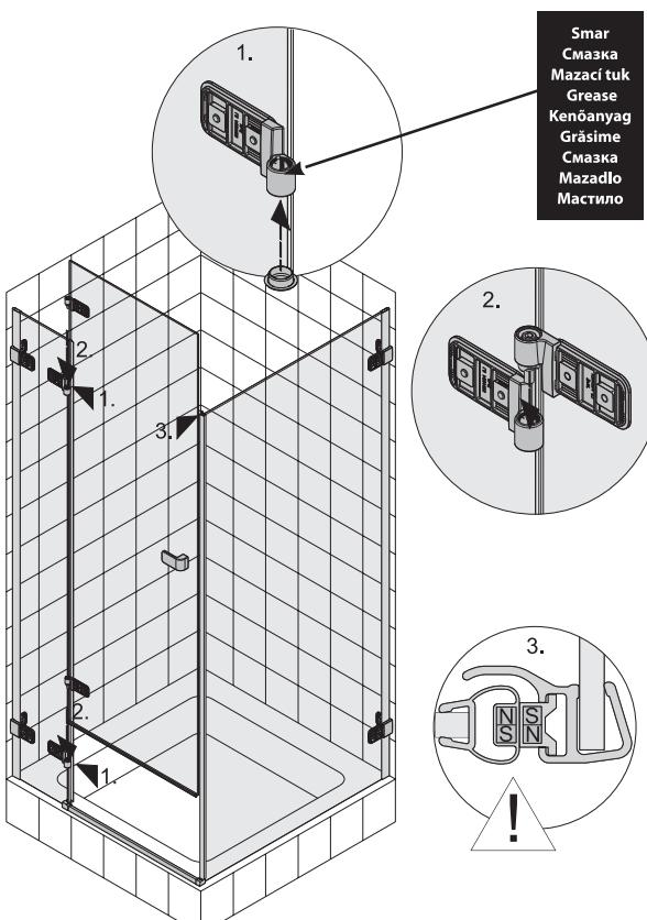
**(PL)** Nałoż dolną zaślepke zawiasu i posmaruj wewnętrzne części zawiasów przykręconych do elementu stałego drzwi, a następnie zamocuj drzwi łącząc ze sobą elementy zawiasów. Upewnij się, że magnesy w uszczelkach (drzwiowej i ścianki) łączą się ze sobą.
