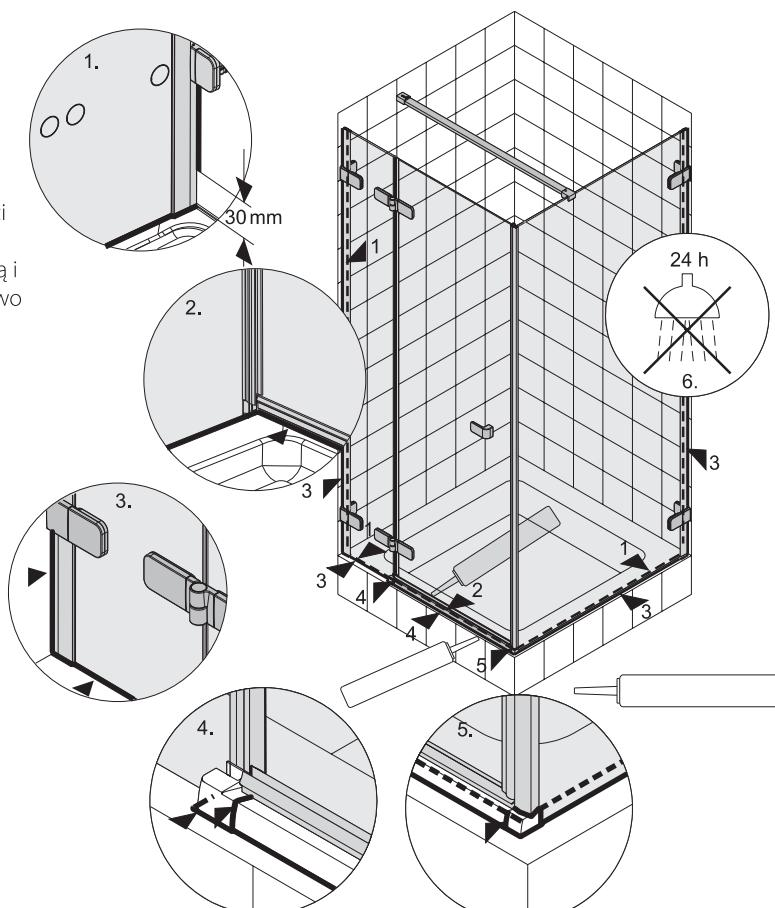
**(RUS)** С внутренней стороны кабины уплотните санитарным силиконом соединения нижних краев стенки двери, неподвижной стенки и нижнего профиля с поддоном. С внешней стороны кабины уплотните соединения боковых и нижних краев кабины со стеной и поддоном, а также нижнего профиля с поддоном. Дополнительно уплотните соединение нижнего профиля соединителями. После завершения монтажа кабиной нельзя пользоваться на протяжение 24 часов. Это время нужно для соответствующего затвердения силикона.
