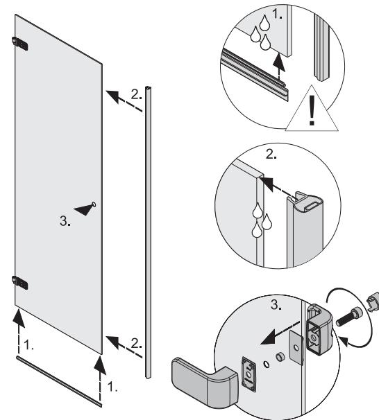
**(SK)** Nasadte magnetickú tesniacu lištu na dvere. Predtím navlhčite okraj skla mydlovým roztokom, montáž magnetickej tesniacej lišty sa tým zjednoduší. Spodnú tesniacu lištu nasadte na dolný okraj dverí a zarovnajte ju s magnetickou tesniacou lištou. Pripojte na dvere držadlo.
