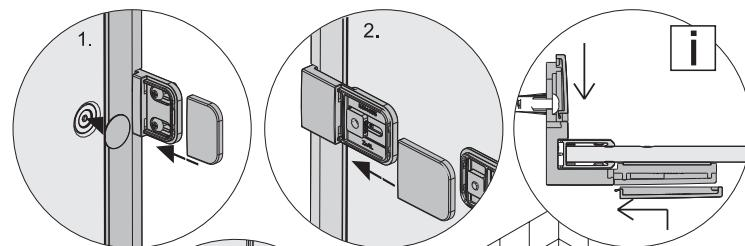
**BG** Закрепете монтажни винтови покриващи елементи на фиксираните подпори на вратата и стените върху външната и вътрешната повърхност на душ кабината. След което прикрепете монтажни винтови покриващи елементи на паните на вратата.
