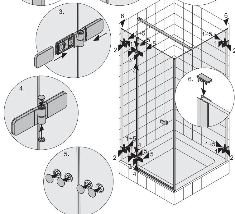
**(RO)** Fixați elementele de acoperire a șuruburilor de instalare a consolelor de susținere a ușii fixe și peretelui pe suprafața interioară și cea exterioară a cabinei de duș. Apoi, fixați elementele de acoperire a șuruburilor de instalare a balamalelor ușilor.
