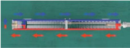
Der Therm X2 arbeitet mit dem innovativen Prinzip der seriellen Durchströmung. Das heißt: Während bei der bisherigen Flachheizkörper-Technik alle Platten gleichzeitig erwärmt werden, wird hier die Frontplatte zuerst durchströmt. Das Ergebnis: Bis zu 11 % Energieersparnis gegenüber herkömmlicher Flachheizkörper-technik. Bis zu 25 % kürzere Aufheizzeit des Heizkörpers. Und bis zu 100 % mehr behagliche Strahlungswärme.
