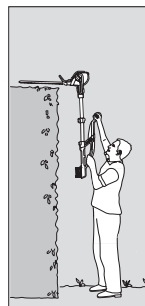
Horizontální stříh ve výšce: Motorová jednotka skloněná o 75°, teleskopická trubka prodloužena
