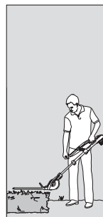
Stříh nízko u země: Motorová jednotka skloněná o 60°, teleskopická trubka prodloužena
