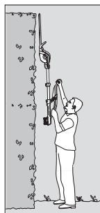
Vertikální stříh ve výšce: Prodlužte teleskopickou trubku
