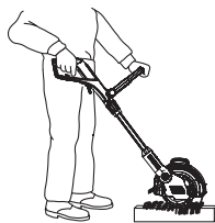
Pracovní poloha 3: Svislé trimování přečnivajících hran trávníku
