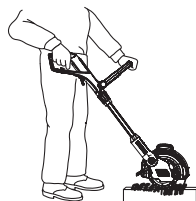
Pracovní poloha 3: Svislé trimování přečnivajících hran trávníku
