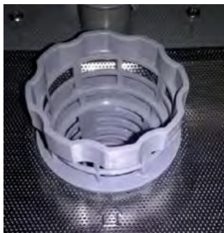
špatně zajištěný filtr
