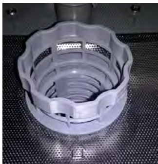
špatně zajištěný filtr
