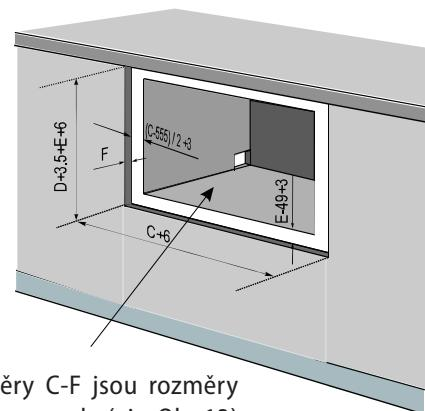
Rozměry C-F jsou rozměry čelního panelu (viz. Obr 13)
