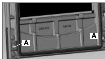
Obr. 2 montáž dolního čela
