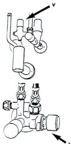
U tlakové instalace zkontrolujte pravidelně jednou měsíčně funkci bezpečnostního ventilu.
