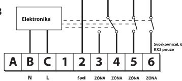
1) V systémech napájených ze sítě propojte svorku 2 k přívodu napájecího napětí.
