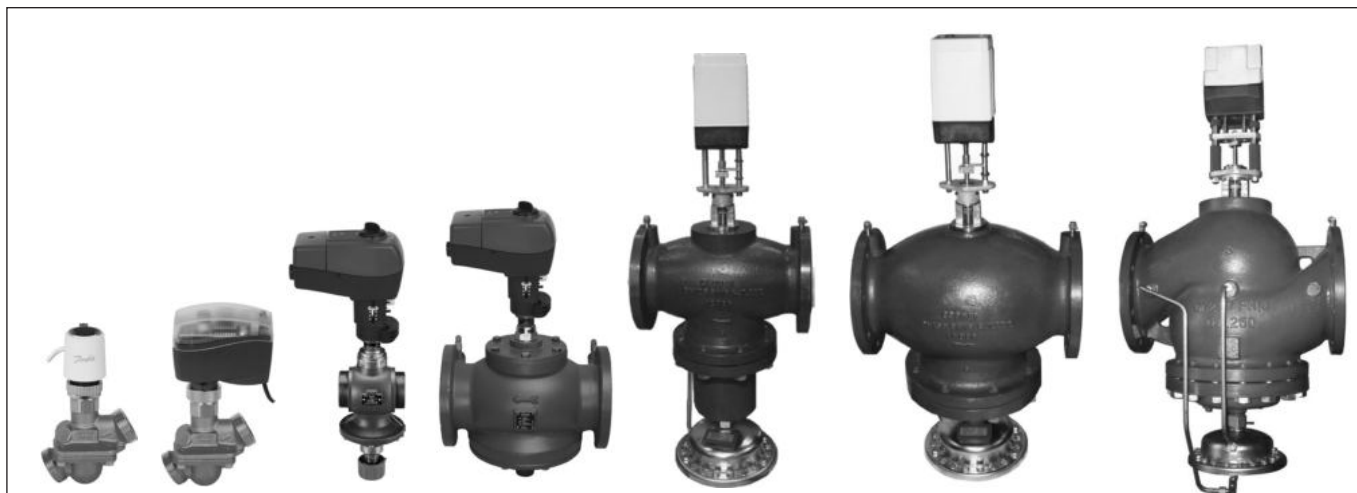
AB-QM ventil, vybavený servopohonem, představuje regulační ventil s plnou autoritou a automatický seřizovací (vyvažovací) ventil omezovač průtoku. Typická použití: Regulace teploty a automatické vyvažování koncových jednotek (vzduchotechnická zařízení, akumulátory tepla/chlady, apod.)
