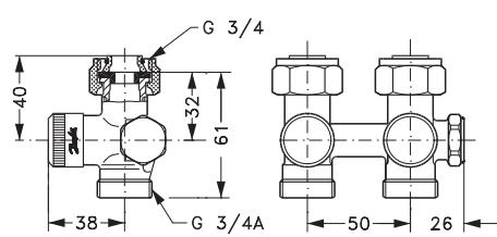
*RLV-K rohové s připojovacím hrdlem na topné těleso G3/4*
