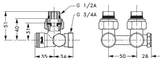
*RLV-K přímé s připojovacím hrdlem na topné těleso G3/4*
