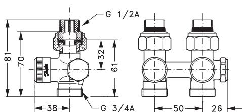
*RLV-K rohové s připojovacím hrdlem na topné těleso G1/2 A*
