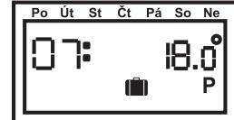
Od této chvíle termostat bude 7 dní udržovat konstantní teplotu 18°C. Vždy o půlnoci je odečten jeden den z nastaveného celkového počtu dní (na displeji se vždy ukazuje zbývající počet dní dovolené).
