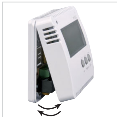
Obr.4 Nasad'te díl s elektronikou na spodní část a zajistěte aretačním šroubem.
