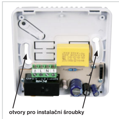
Obr.4 Nasad'te díl s elektronikou na spodní část a zajistěte aretačním šroubem.
