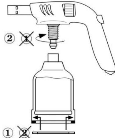
Pozn.: Při šroubování horní a spodní části k sobě dojde k proniknutí propichovací jehly ventilu stěnovou kartuše, což se projeví syčením unikajícího plynu. Tento jev je normální a je proto nutné, aby zašroubování, ve fázi kdy dochází k úniku plynu, bylo prováděno co nejrychleji.
