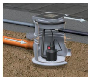
Mono-Hebeanlage für Grauwasser
