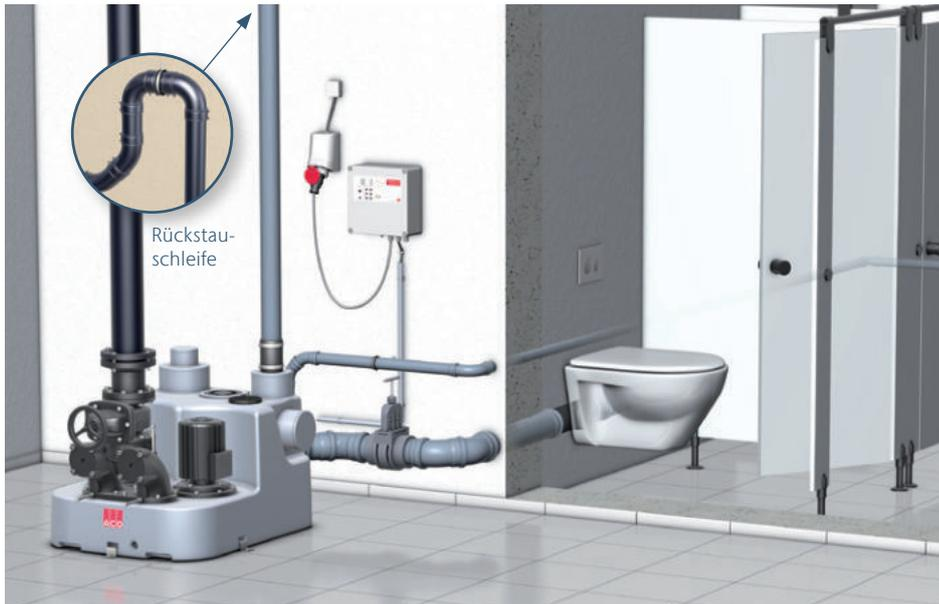
Bei der Entwässerung von gewerblich genutzten Bereichen oder Mehrfamilienhäusern darf der Abwasserzufluss nicht unterbrochen werden. Nach DIN 1986-100 ist für solche Anwendungsfälle eine Doppelhebeanlage einzubauen.
