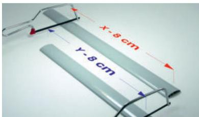
4. Die zwei längeren Profilstücke werden auf X-Maß minus 8 cm zugesägt. Die zwei kürzeren Profilstücke werden auf Y-Maß minus 8 cm zugesägt.
