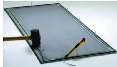
10. Richten Sie das Gewebe auf der Abdeckung aus. Fixieren Sie das Gewebe mittels des Einschlagkeder, wie im Bild dargestellt. Anschließend schneiden Sie das Gewebe rund um den Keder ab.
