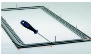
9. Schneiden Sie die Bürstendichtungen auf die jeweilige Länge. Drücken Sie die Bürsten in die Eckverbinder-Nut und schieben diese in die Profil-Nut. Anschließend schieben Sie ggf. ein Stück Bürstendichtung in das Wandanschlussprofil.
