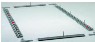
5. Legen Sie die zugesägten Profile auf einen festem Untergrund aus. Bevor Sie die Profile zusammenstecken, führen Sie die Sechskantschrauben in die vorgesehene Profilnut.
