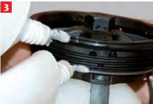
3 Dichtungen an der Rückstaeinheit einfetten
