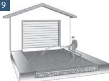
Auf dem Unterbau wird eine ca. 4 cm dicke Ausgleichsschicht als Planum aus Sand oder für besseres Wachstum ein Gemisch aus gesiebtetem Kompost mit Sand/Lava aufgebracht. Dünne Rohre dienen als Niveauhilfe seitlich. Darauf wird mit einer Abziehschiene die Ausgleichsschicht glatt gezogen.
