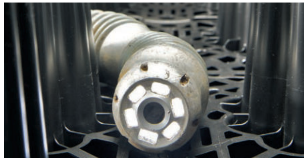
Schiebekamera, Reinigungsgerät mit Spülkopf
