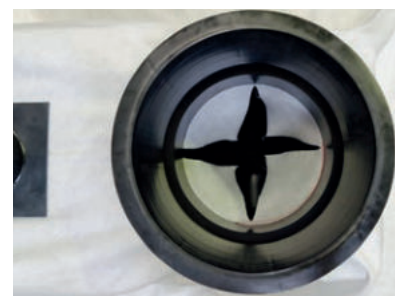
Montage des Zwischenteils (= sanddicht)
