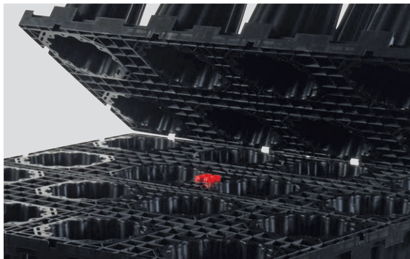
ACO Stormbrixx SD: Zwei zusammengesteckte Verbinder sichern die Ausrichtung der Pylonen zweier Einbaulagen
