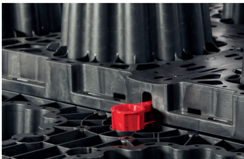
ACO Stormbrixx HD: Zwei zusammengesteckte Verbinder sichern die Ausrichtung der Pylonen zweier Einbaulagen
