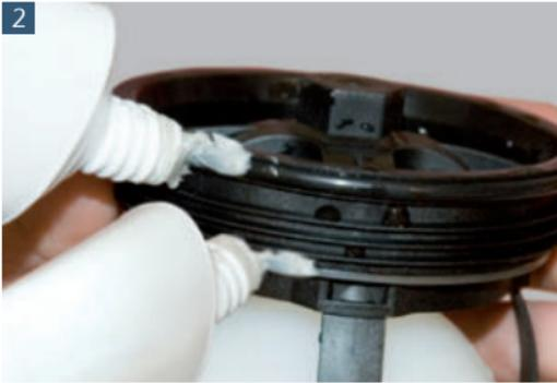
Die Rückstaeinheit kann separat bestellt werden (beim Rückstauverschluss im Lieferumfang enthalten). Vor dem Einsetzen den O-Ring und die Dichtlippe dünn mit Gleitmittel bestreichen.
