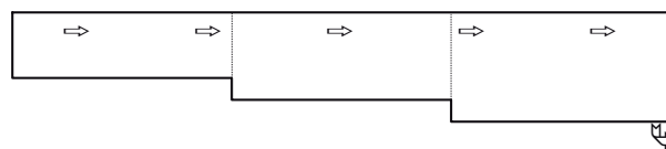
Stufengefälle (Rinnenkörper mit unterschiedlichen Bauhöhen)
