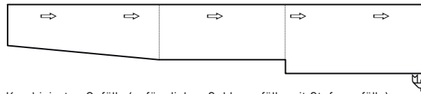
Kombiniertes Gefälle (anfängliches Sohlgefälle mit Stufengefälle)
