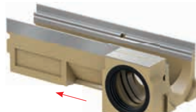
Seitlicher Rohranschluss am 0,5-m-Element über die geöffnete Vorformung mittels Adapter und Stirnwand mit eingeformter Dichtung
