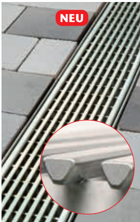
Heelsafe Rost Edelstahl Nennweite 100 Belastungsklasse B 125
