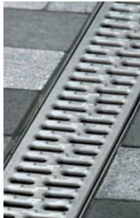
Stegrost Edelstahl Nennweite 100 Belastungsklassen: A 15 und C 250
