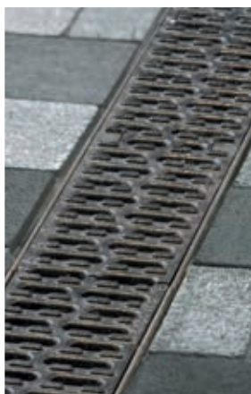
Stegrost Gusseisen Nennweiten: 100, 150, 200, 300, 400, 500 Belastungsklassen: B 125, C 250, D 400 und E 600
