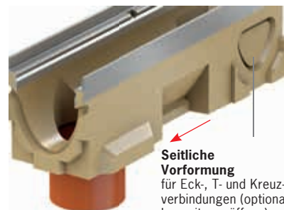
Senkrechter Grundleitungsanschluss über eine eingeformte Dichtung in der Rinnensohle (beim 0,5-m- und 1,0-m-Element)
