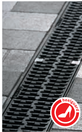
Stegrost „Heelguard“ Gusseisen EN-GJS Schlitzweite nur 5 mm Nennweite 100 Belastungsklasse C 250
