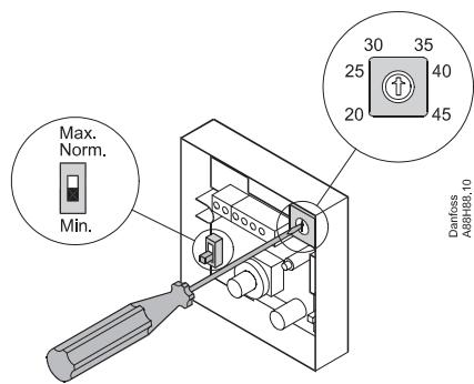
Gulvføler / Floor Sensor / Fußbodenfühler /
